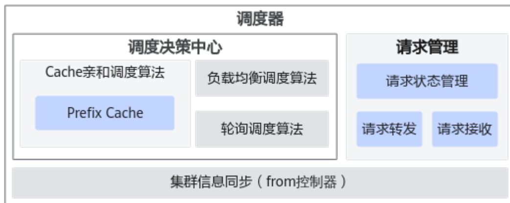
图 8-6 调度器（Coordinator）架构图
