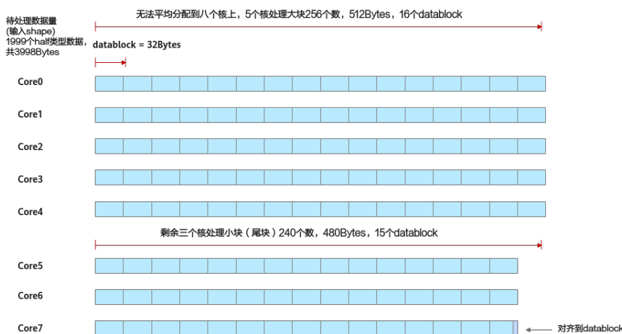
图 7-18 无法均分到每个核上的示例
